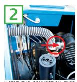
INSERT THE CONNECTION TUBE TO THE SUCTION FILTER OF THE HIGH PRESSURE COMPRESSOR
