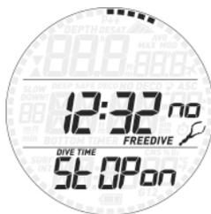
Режим дисплея **pre-dive** переводит компьютер в режим ожидания перед погружением и Smart Arnea начинает отслеживать погружение по достижении глубины 1,2 м. Если вы начнёте погружение без установки режима **pre-dive** на Smart Arnea, то отслеживание погружения начнётся автоматически, но с задержкой в 20 секунд после погружения.
