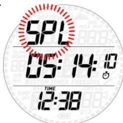
Секундомер имеет также функцию промежуточного времени: при нажатии нижней кнопки во время работы секундомера, время остановится и знак **SP** будет мигать в верхнем ряду, а секундомер при этом продолжит работать. При каждом нажатии нижней кнопки промежуточное время будет обновляться. Нажмите и удерживайте нижнюю кнопку, чтобы выйти из режима промежуточного времени; верхняя кнопка не имеет функций.
