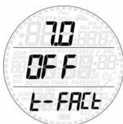
Минимальный интервал на поверхности определяется следующим образом: продолжительность предыдущего погружения умножается на t-фактор. T-фактор можно установить от 1 до 7 с увеличением на 0,5.
