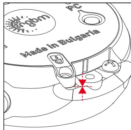
и) Удерживайте крышку на компьютере, закручивая при этом два винта. Не давите сильно на крышку. Идеальное давление - 12 Н см / 17 унция-дюйм.
