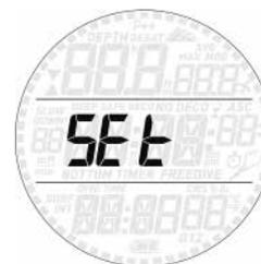
Меню установок/ **SET** компьютера Smart Arnea позволяет изменять настройки. Войдя в меню, нажмите любую кнопку для прокрутки двух меню: установка погружения/**SET DIVE**, где вы можете установить параметры, которые относятся к погружению, и установка часов/**SET TIME**, где вы можете установить параметры, относящиеся ко времени и дате.
