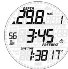
При нажатии верхней кнопки на дисплее в верхнем ряду в течение пяти секунд отображается максимальная глубина в дайв-сессии и количество погружений в дайв-сессии, в среднем ряду - максимальная скорость всплытия и погружения за сессию (чередуются) и интервал на поверхности, и в нижнем ряду - самое долгое погружение за дайв-сессию и минимальная температура в сессии. Более того, для более понятного различия между данными о погружении и данными о дайв-сессии, в последней
