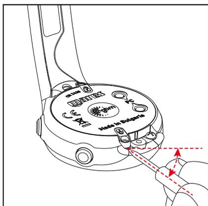
г) Снимите крышку, а затем уплотнительное кольцо. Выбросьте кольцо.
