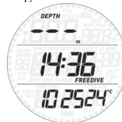
Режим дисплея **pre-dive display** показывает время суток и температуру. Четырёхзначное число в нижнем левом ряду означает плотность воды, которая указана без десятичной запятой. См. раздел 2.3.1 для получения более подробной информации об установке плотности воды.
