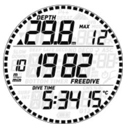
Дисплей показывает глубину, время, температуру и другие параметры погружения.
