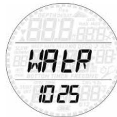
В отличие от большинства компьютеров для дайвинга и подводной охоты, которые позволяют выбирать только между пресной и солёной водой, на компьютере Smart Arnea можно установить плотность воды от 1.000 (пресная вода) до 1.050 с увеличением на 0.001. Установка по умолчанию - 1.025, что в установках Mares соответствует солёной воде.
