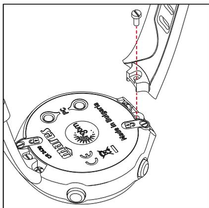
б) Снимите два винта рядом с символом замка. Винты удерживают крышку батарейного отсека на месте.
